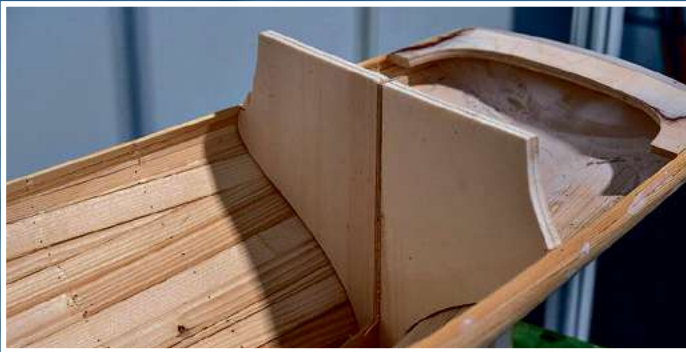
Dieses Boot wird klassisch über Mallen gebaut.
