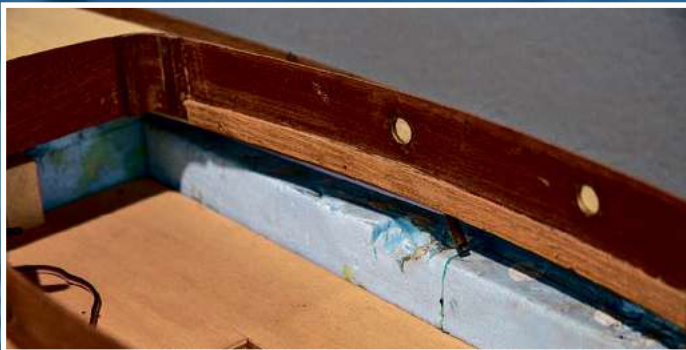
Bei diesem Modell besteht der Rumpf aus Styrodur.
