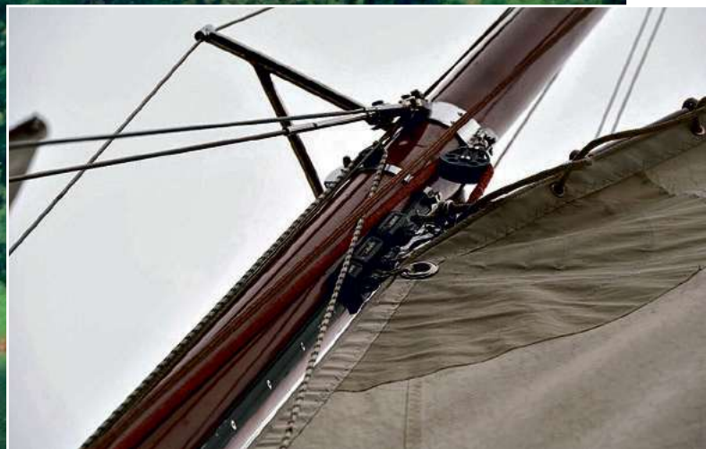
Kugelgelagerte Rutscher auf Schienen machen das Segelsetzen zum Kinderspiel.
